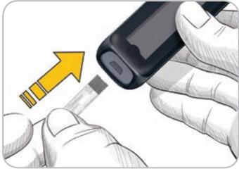
4. Insérer fermement l'extrémité carrée grise de la bandelette dans le port d'insertion jusqu'à l'émission d'un bip par le lecteur.
